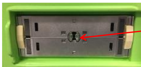
図 20 : トランスデューサコネクタスロットのロックノッチ
